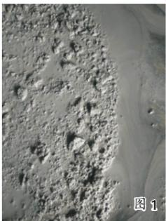
调整不及时,会导致出厂混凝土易离析现象(如图1),影响到混凝土公司正常生产(如堵管、混凝土滞留等一系列问题),若处理不当将直接影响混凝土产品的质量。为了有效处理离析混凝土的技术难题,为此试验室对商品混凝土离析后的处理进行了研究和大量的试验,目的是避免因试验室质检员处理不当而造成混凝土性能不合格或质量事故,希望对离析的商品混凝土得到规范化处理方法,以达到科学合理地利用离析混凝土。
